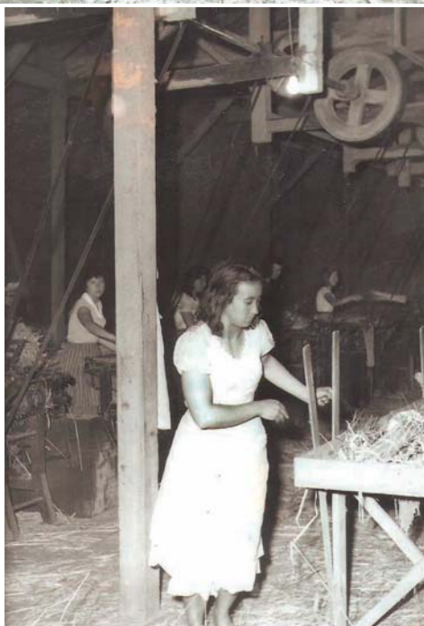
Na fábrica de palhões, os litros eram trançados com palha de trigo, evitando que quebrassem durante o transporte. Foto: arquivo Barão, 30/04/1956
