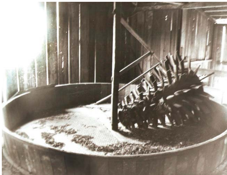
Na cancha do barbaquí era colocada a erva já seca através de um sistema de canalização de calor. Depois disso, um cavalo circulava a cancha puxando a madeira maior, moendo assim a erva que caía na parte de baixo através de furos feitos no chão. Na parte de baixo ela era recolhida e posteriormente comercializada. Foto: Sandra M. Mosson, 1999
